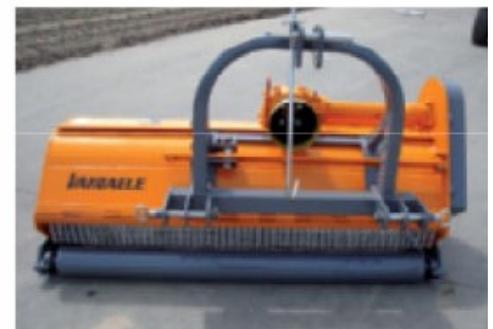
Rodillo de altura ajustable montado en la parte trasera (opcional).
