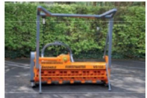
Barra frontal protectora, mecánica y ajustable con carcasa adicional reforzada (opcional).
