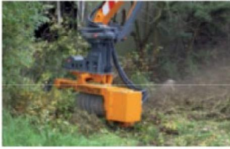
Modelo hidráulico para conectar a un brazo de grúa o a un brazo de poda.
